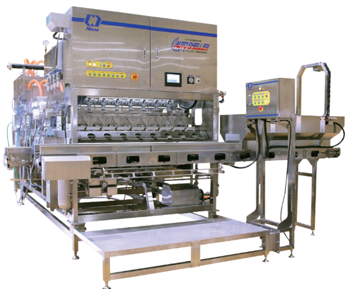
△世界初のホタテ貝生剥き装置 「オートシェラー」
